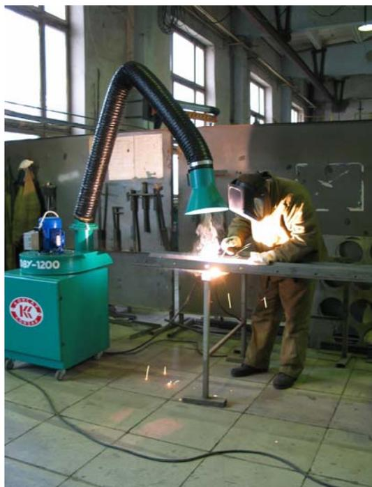
Установки серии «ФВУ» предназначены для удаления и очистки воздуха от сварочного аэрозоля, газов и мелкодисперсных аэрозолях, выделяющихся при различных технологических процессах. В установках использован принцип осаждения аэрозолей на электростатическом фильтре, что позволяет достигать высокой степени очистки воздуха и возвращать его в рабочее помещение.
