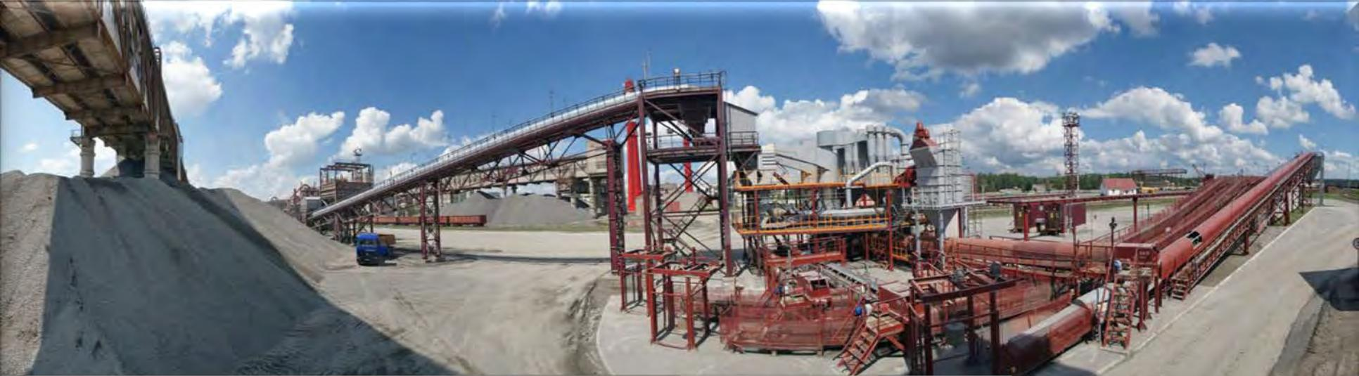
**Комплексы классифицирующие позволяют получать из отсева дробления фракции щебня 0-0,63 мм; 0,63-2 мм; 2-5 мм**
