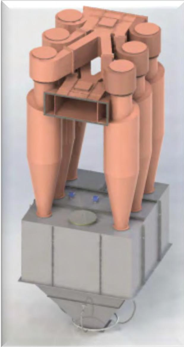
Циклоны предназначены для улавливания из газов взвешенных частиц. В зависимости от требований, предъявляемых к очистке газов, от свойств и дисперсного состава частиц циклоны могут применяться самостоятельно или использоваться в качестве аппаратов первой и второй ступени очистки в сочетании с другими газоочистительными аппаратами.
