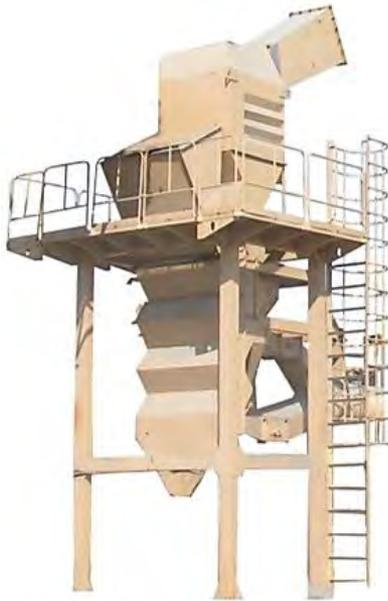
Каскадно-гравитационные классификаторы применяются для разделения крупнодисперсных материалов на заданные фракции в диапазоне крупности от 0,1 до 5,0 мм. Разделение материала происходит за счёт взаимодействия поля гравитационных сил и воздушного потока. В конструкции оборудования реализована каскадная система сепарации, что позволяет добиться высокой точности разделения.
