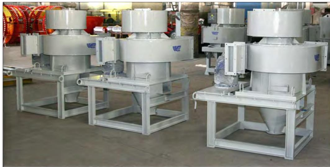
Классификаторы данного типа используются для получения высококачественных наполнителей, пигментов, высокомарочных цементов, микроталька и других материалов. Крупность продуктов разделения регулируется как изменением частоты вращения разгонного ротора, так и путем изменения величины воздушного потока.
