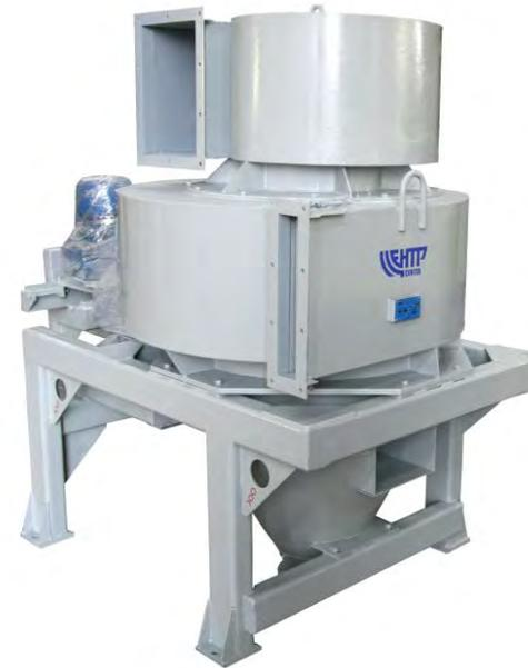
Центробежные классификаторы применяются для получения тонкодисперсных порошков заданного фракционного состава в диапазоне крупности от 0,005 до 0,1 мм. Разделение материала происходит за счёт взаимодействия поля центробежных сил и воздушного потока. Крупность продуктов разделения регулируется как изменением частоты вращения разгонного ротора, так и путем изменения величины воздушного потока.
