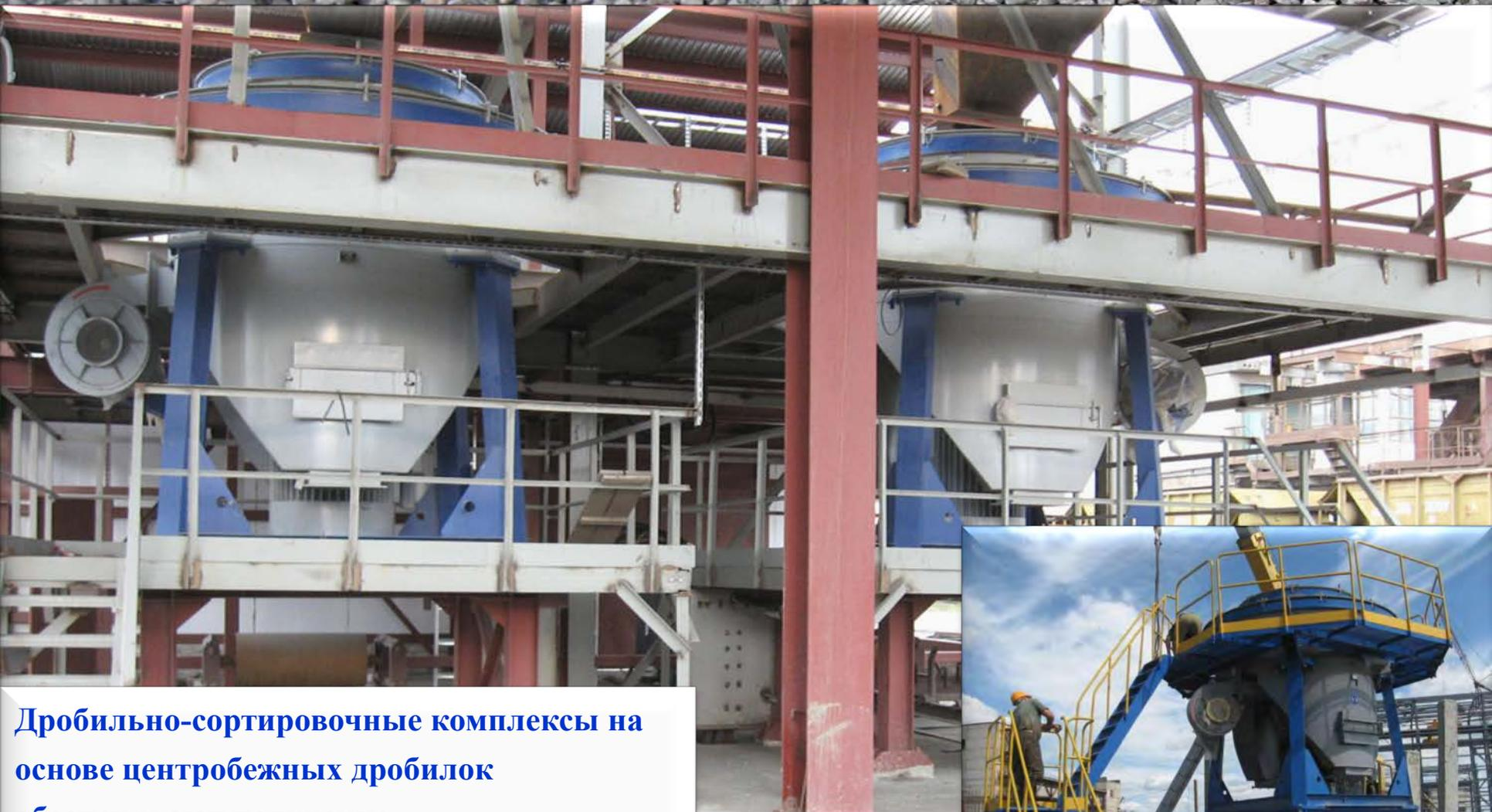
Дробильно-сортировочные комплексы на основе центробежных дробилок обеспечивают получение высококачественного кубовидного щебня и песка в объеме до 1 млн. тонн в год.
