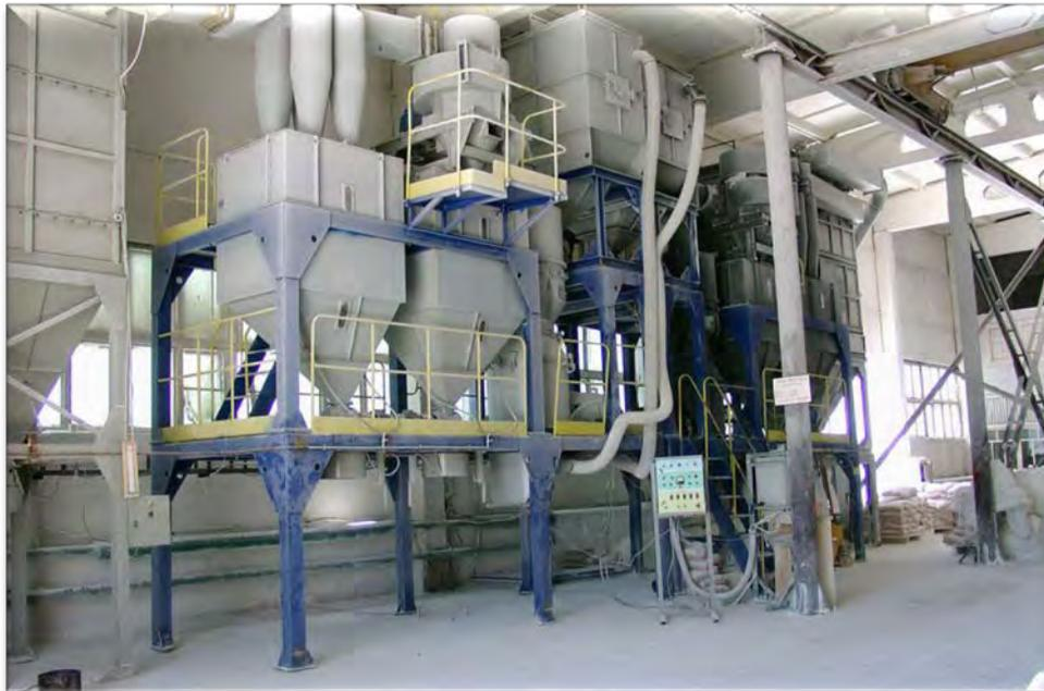
Получаемый на мельница материал отличается узким гранулометрическим составом, низким содержанием как крупных, так и мелких фракций. Частицы имеют однородную изометрическую форму с хорошо развитой поверхностью. Это способствует получению прочных и качественных изделий при снижении материальных (связующие, вода) и энергетических затрат.
