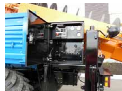
Пульт управления бурильной установкой МБШ
