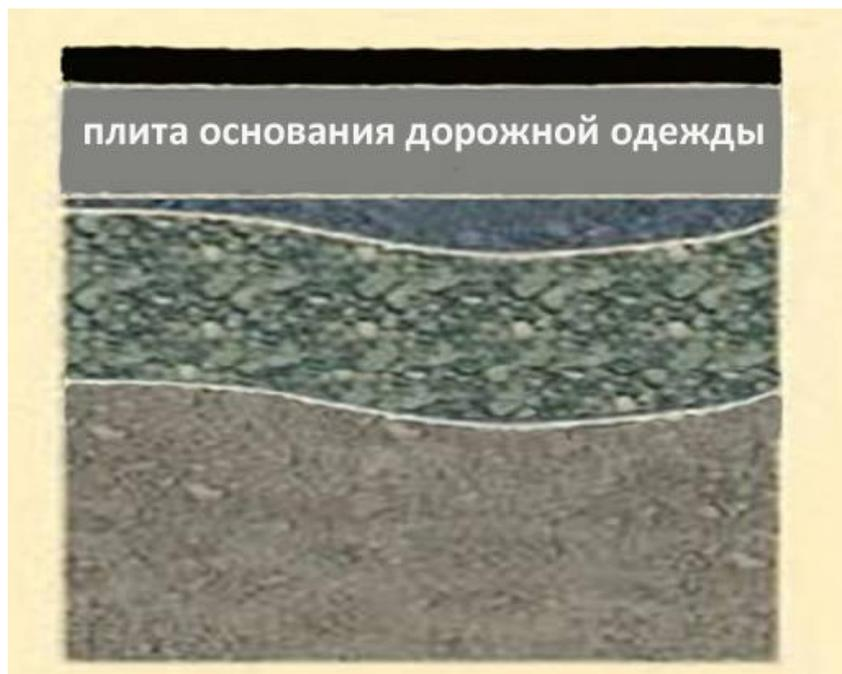
При использовании модификатора «Дорцем ДС-1», создаётся монолитная гидрофобная плита основания дорожной одежды с очень высокими и долговечными эксплуатационными характеристиками.
