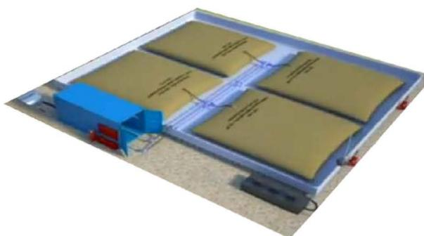
Береговой терминал имеет подъездные пути для приёма груза с автомобильных и железнодорожных цистерн, а также оснащён специальным оборудованием для подогрева масла растительного в холодное время года. Склад оборудован изолированными ПЭР объёмом 250 кубических метров каждый, представляющими собой замкнутые
